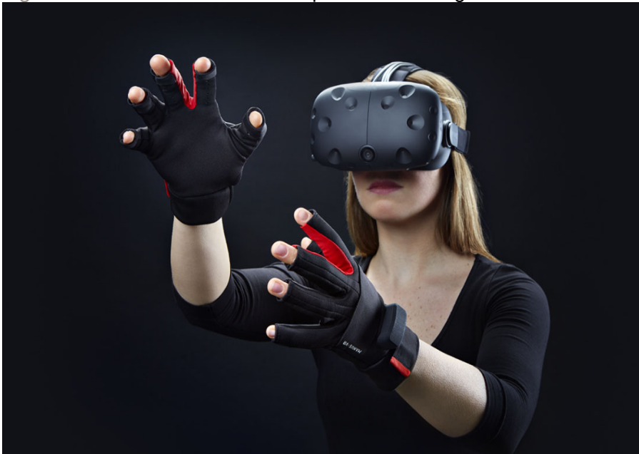
Figuur 4 VR-handschoenen met haptische technologie
